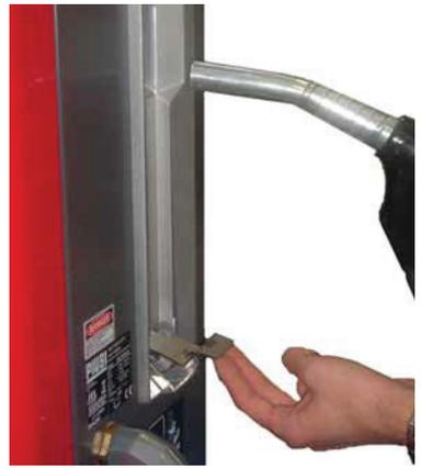
Betätigen Sie den Hebel der automatischen Zapfpistole; halten Sie dabei den Spout in einem geeigneten Behälter
