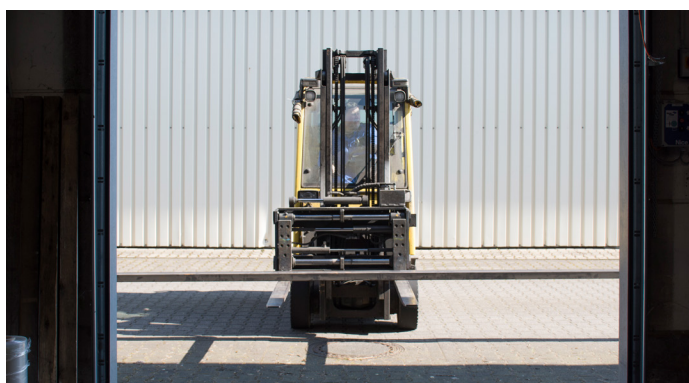
Le passage de portail avec du matériel de grande longueur n'est pas possible sans le LSL
