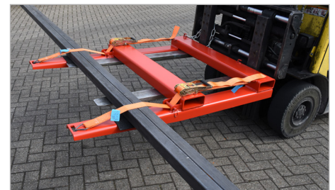
Position de préhension pour charger ou décharger
