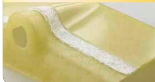
Aufgrund der herausragenden Werkstoffeigenschaften, die durch die Armierung des dreidimensional vernetzten Duroplastmaterials mit Glasfasern entstehen, werden aus GFK seit Jahrzehnten Produkte für hohe Beanspruchung hergestellt, von denen eine lange Lebensdauer in rauer Umgebung und gleichzeitig hohe Sicherheit erwartet wird. GFK verbindet die positiven Eigenschaften von Stahl und Kunststoff.
